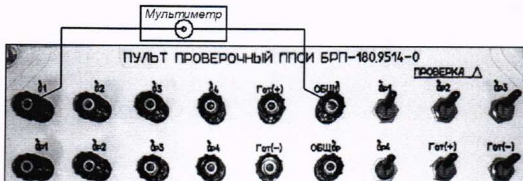
Рисунок 44 – Схема проверки при воспроизведении системой напряжения постоянного тока
