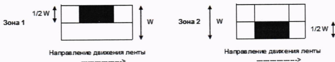
Рисунок 1 — Расположение испытательных нагрузок для СИ
