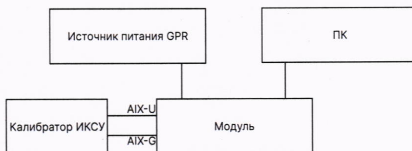
Рисунок 3 – Схема подключений для определения приведенной (к диапазону измерений/преобразований) основной погрешности измерений/преобразований силы постоянного тока (метод прямых измерений)
