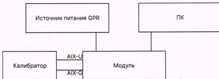
Рисунок 2 – Схема подключений для определения приведенной (к диапазону измерений/преобразований) основной погрешности измерений/преобразований напряжения постоянного тока
