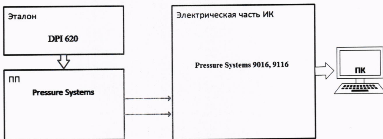
Рисунок 1 – Схема поверки ИК МИД
