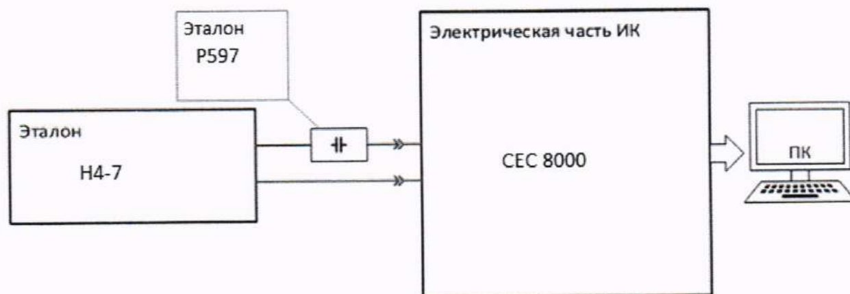
Рисунок 7 – Схема поверки ИК МИВиБ при использовании меры емкости и генератора напряжения переменного тока
