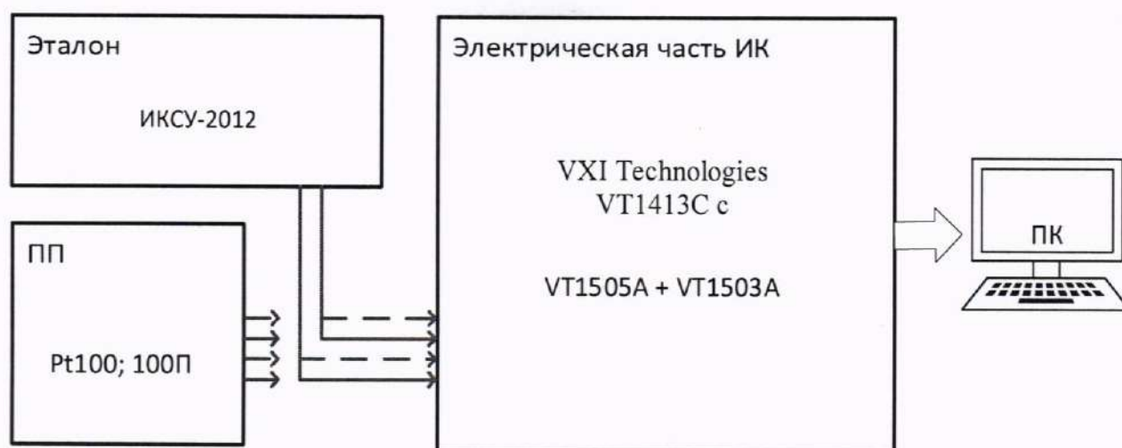
Рисунок 4 – Схема поверки ИК МИТ с ПП терморезистивного типа
