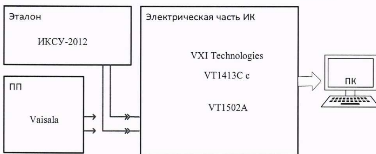
Рисунок 5 – Схема поверки ИК МИТ с ПП с унифицированным токовым выходом
