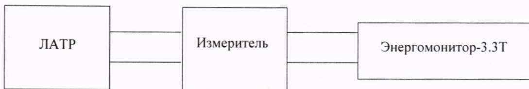
Рисунок 1 – Структурная схема определения абсолютной погрешности измерений воспроизведенных значений напряжения переменного тока
