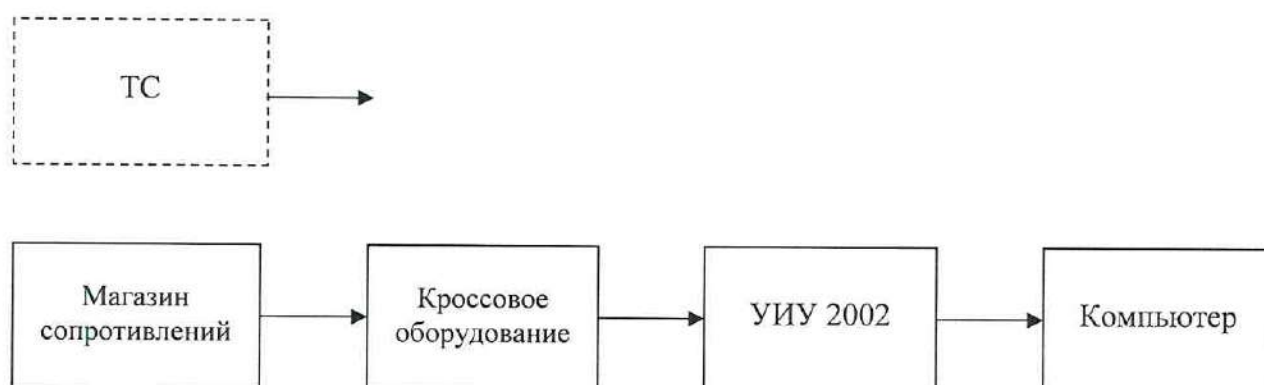
а) Схема определения метрологических характеристик комплектным способом
