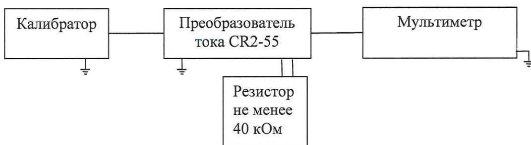
Рисунок 2 - Схема поверки при первичных токах до 50 А
