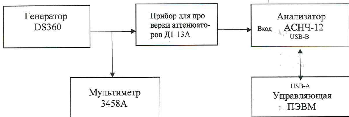
Рисунок 3 – Блок-схема проверки диапазона измерений напряжения переменного тока и относительной погрешности измерений напряжения переменного тока в диапазоне значений от 2 \cdot 10^{-8} до 4,5 В
