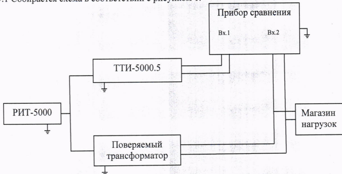
Рисунок 1 – Схема определения токовых и угловых погрешностей трансформаторов
