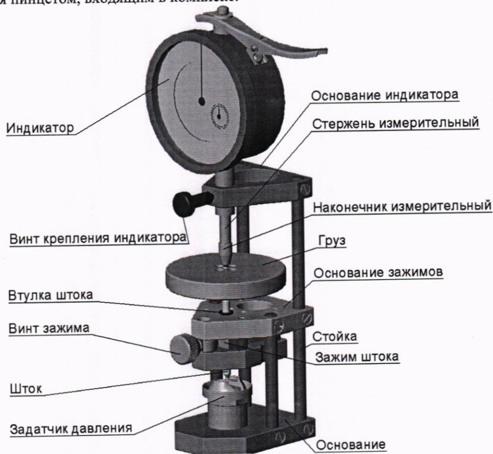
Рисунок 1 - Измерение величины деформации пружины задатчика давления
