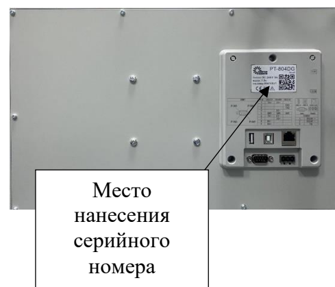
Рисунок 2 – Общий вид обратной стороны панели и место нанесения серийного номера
