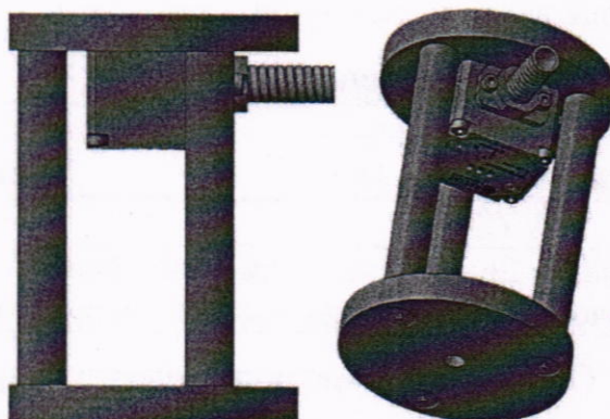
Рисунок 4 – Схема установки датчика в оснастке по измерительной оси Z
