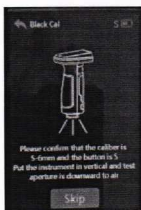
Рисунок 7 - Окно калибровки «нуля» моделей DS-700D и DS-700C
