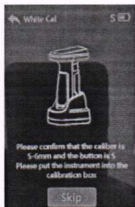
Рисунок 5 - Окно калибровки по белому образцу моделей DS-700D и DS-700C
