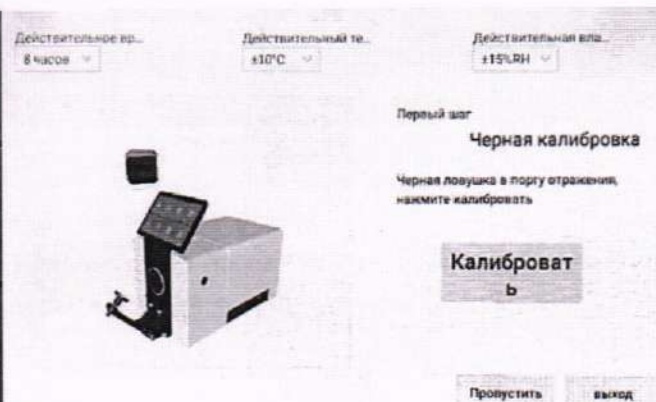
Рисунок 3 - Экран процедуры калибровки «нуля»
