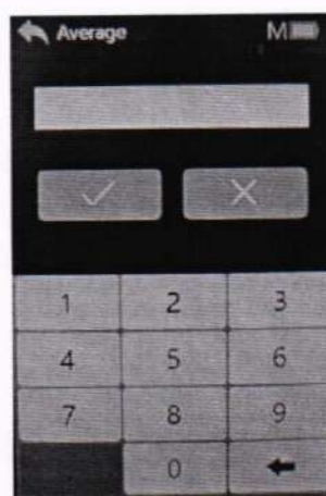
Рисунок 16 - Окно настройки усреднения измерений спектрофотометров моделей DS-700D и DS-700C
