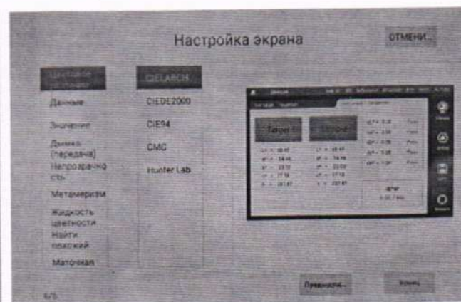
Рисунок 13 - Окно выбора колориметрической системы спектрофотометров моделей CS-821N и CS-822
