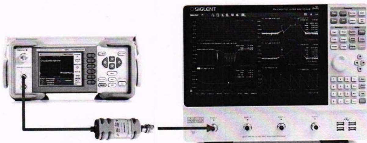
Рисунок 2 – Схема соединения приборов для определения диапазона установки уровня выходной мощности и абсолютной погрешности установки уровня мощности
