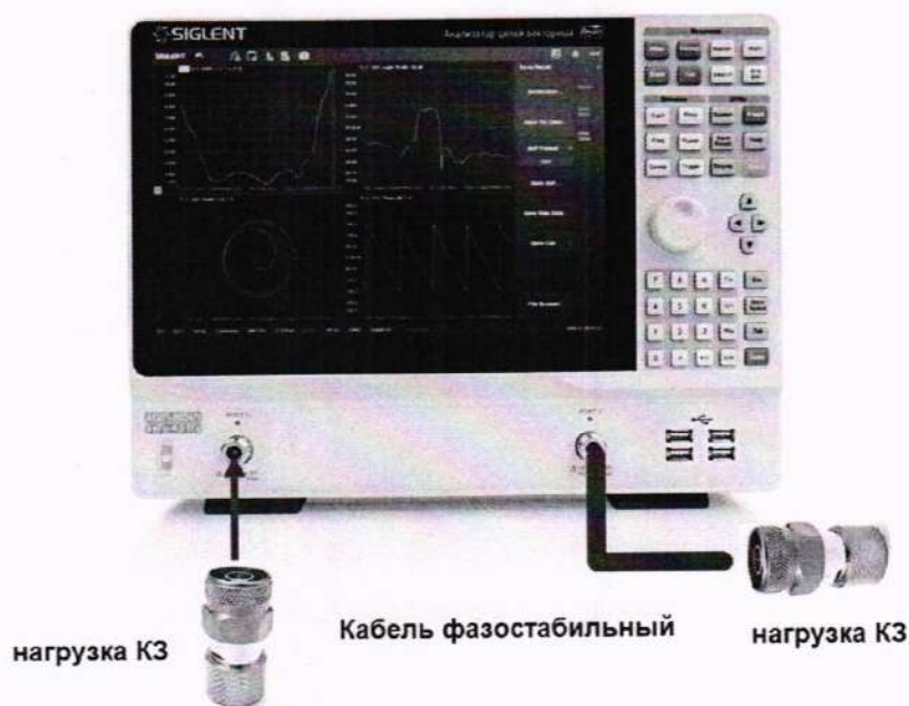
Рисунок 5 – Схема соединения приборов для измерения среднеквадратического отклонения шумов измерительного тракта
