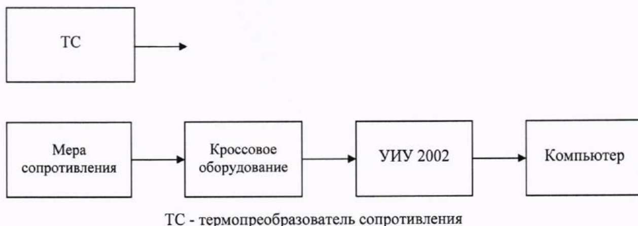
Рисунок 3 - Схема определения метрологических характеристик ИК температуры (с термопреобразователями сопротивления) поэлементным способом
