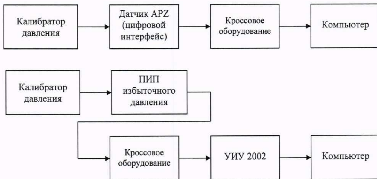
а) Схема определения метрологических характеристик комплектным способом
