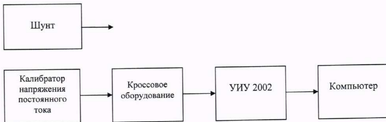
Рисунок 9 - Схема определения метрологических характеристик ИК силы постоянного тока (с шунтами)
