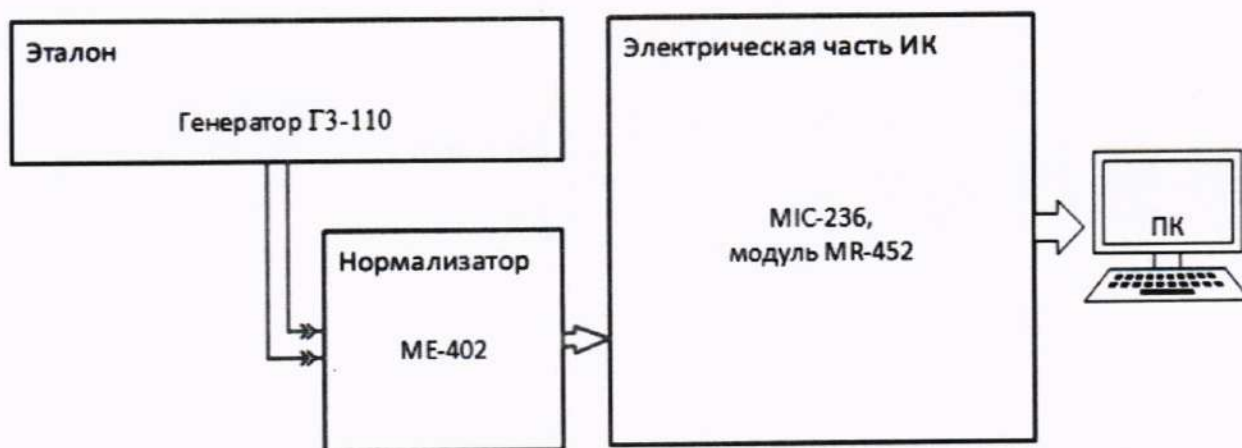
Рисунок 24 – Схема поверки ИК частоты переменного тока генератора
