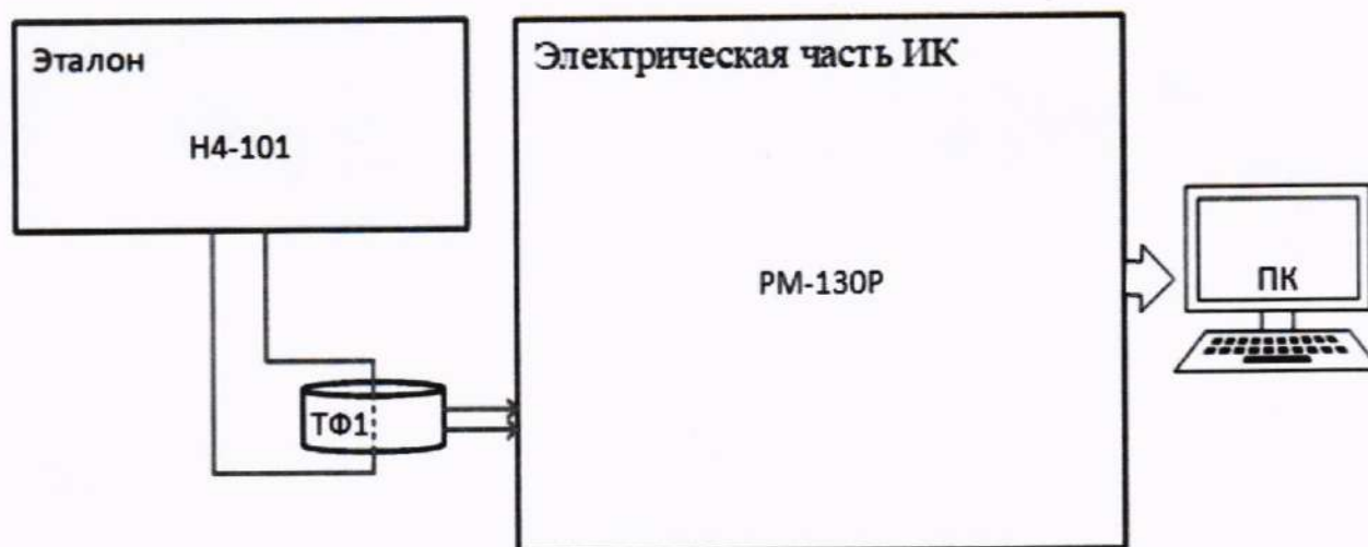
Рисунок 29 – Схема поверки ИК силы переменного тока
