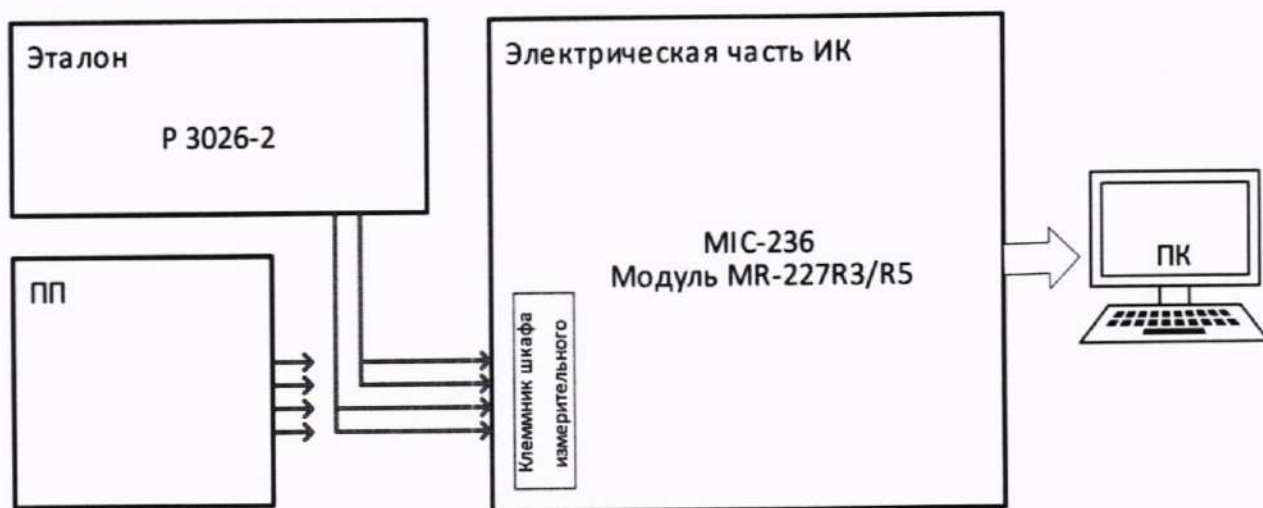
Рисунок 19 – Схема поверки ИК сопротивления постоянному току, соответствующего температуре
