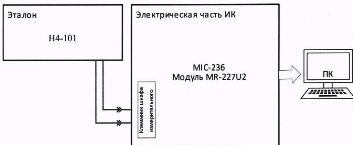
Рисунок 26 – Схема поверки электрической части ИК напряжения постоянного тока
