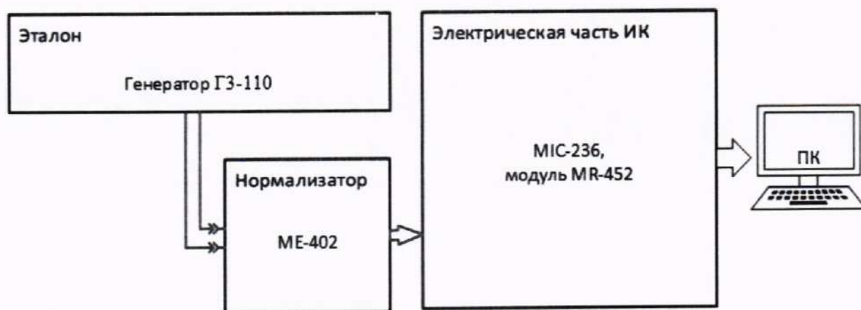
Рисунок 23 – Схема поверки ИК частоты (сигналов переменного тока, соответствующих частоте вращения ротора)
