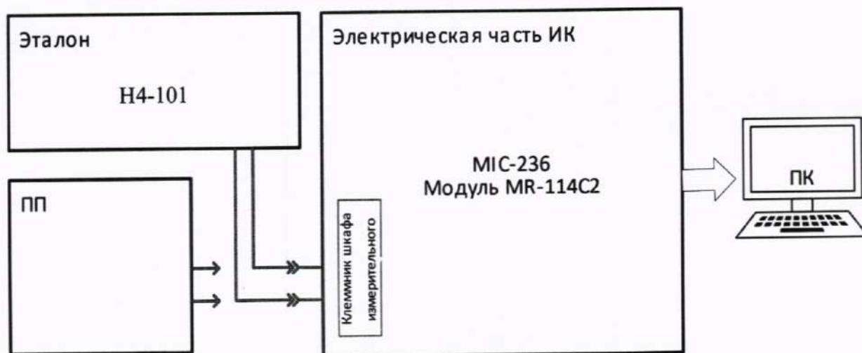
Рисунок 22 – Схема поверки ИК напряжения постоянного тока, соответствующего давлению
