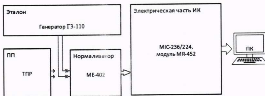
Рисунок 25 – Схема поверки ИК объемного расхода (прокачки) жидкостей
