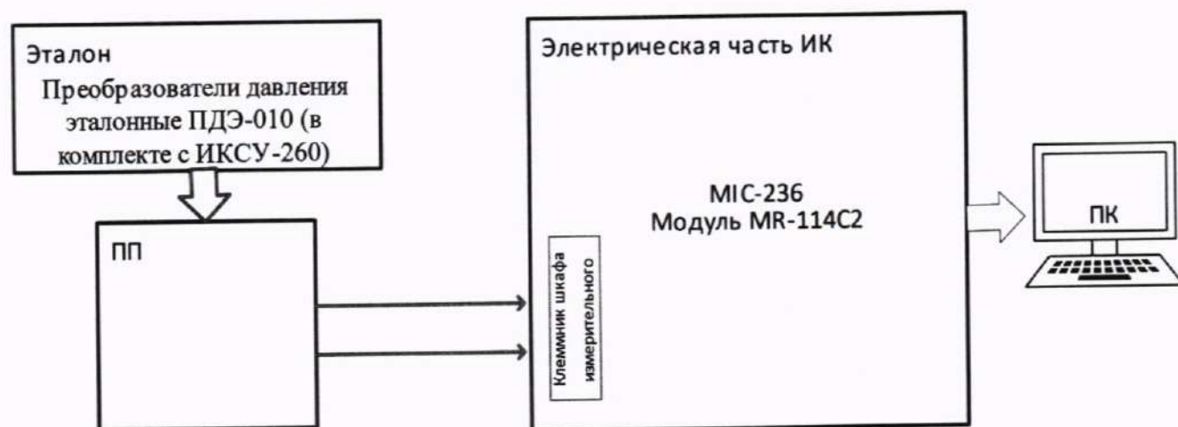
Рисунок 21 – Схема поверки ИК давления газов и жидкостей комплектным способом
