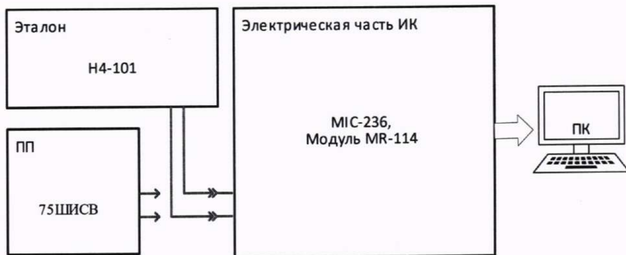
Рисунок 28 – Схема поверки электрической части ИК силы постоянного тока
