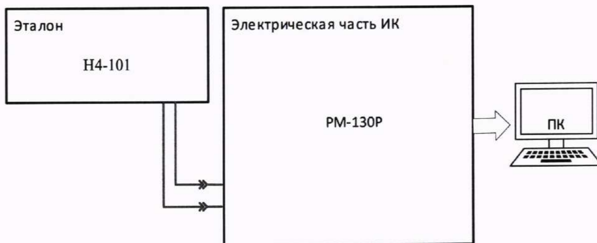
Рисунок 27 – Схема поверки электрической части ИК напряжения переменного тока
