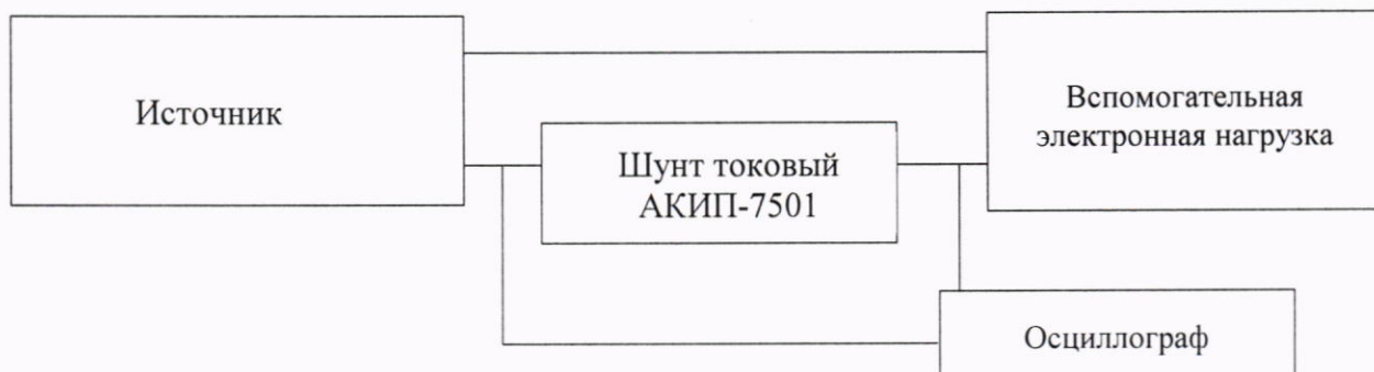
Рисунок 7 - Структурная схема определения уровня пульсаций выходного сигнала силы постоянного тока в режиме стабилизации силы постоянного тока
