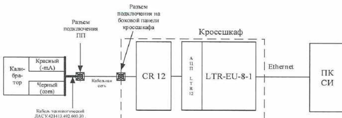
Рисунок 12 – Схема поверки ИК измерения избыточного давления.
