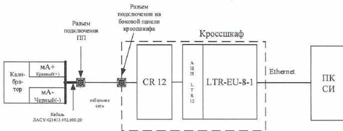
Рисунок 27 – Схема поверки ИК расхода среды
