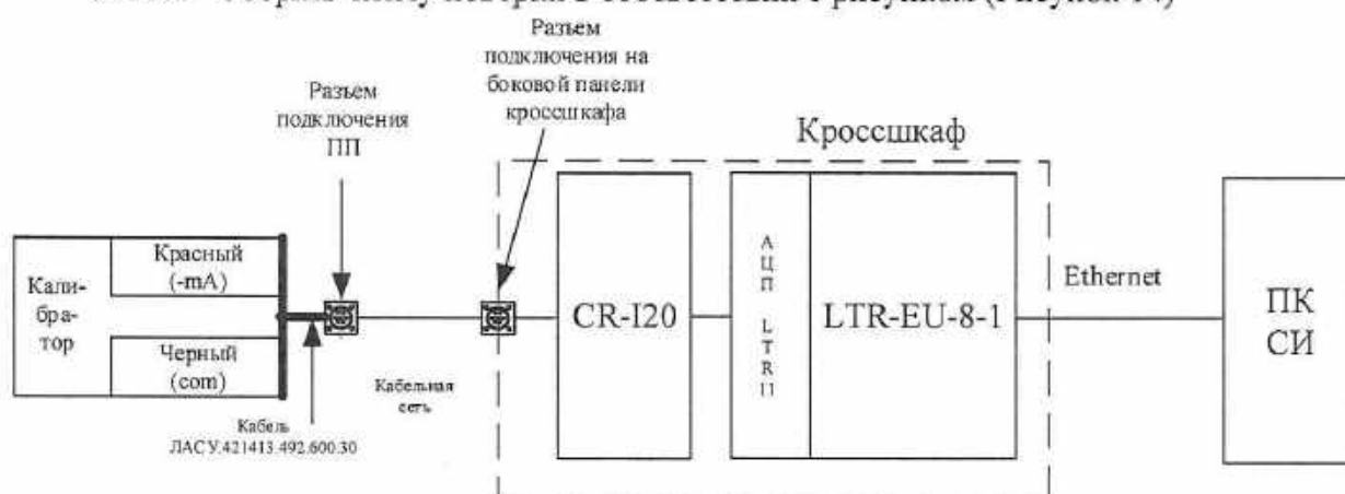
Рисунок 14 – Схема поверки ИК пульсации давления.
