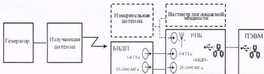
Рисунок 4 – Схема измерений напряженности электромагнитного поля
