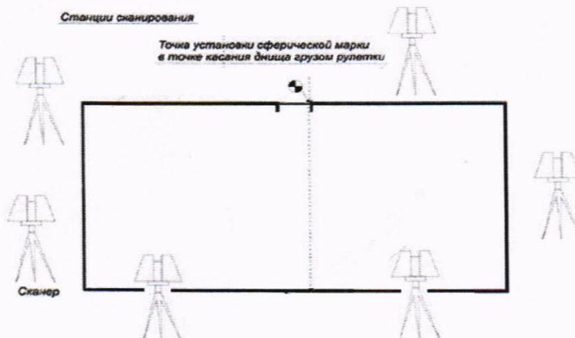
Рисунок А.3 - Схема сканирования внешней поверхности резервуара
