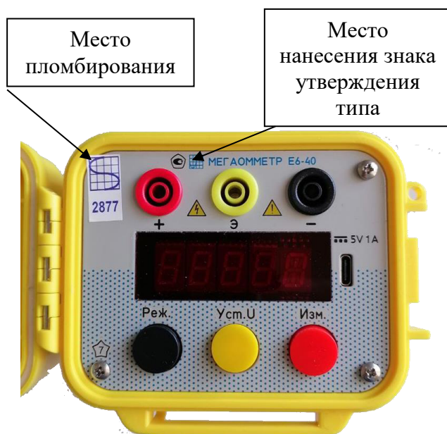
Рисунок 1 – Общий вид мегаомметров Е6-40 (вертикальное исполнение корпуса)
