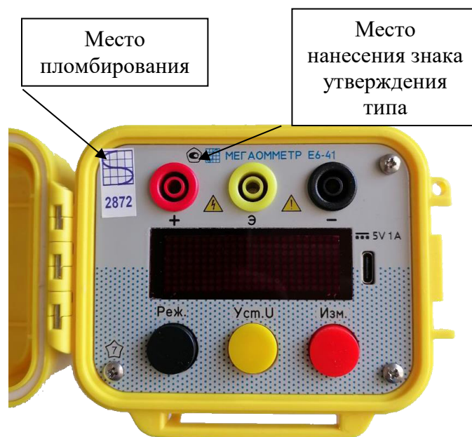
Рисунок 2 – Общий вид мегаомметров Е6-41 (вертикальное исполнение корпуса)
