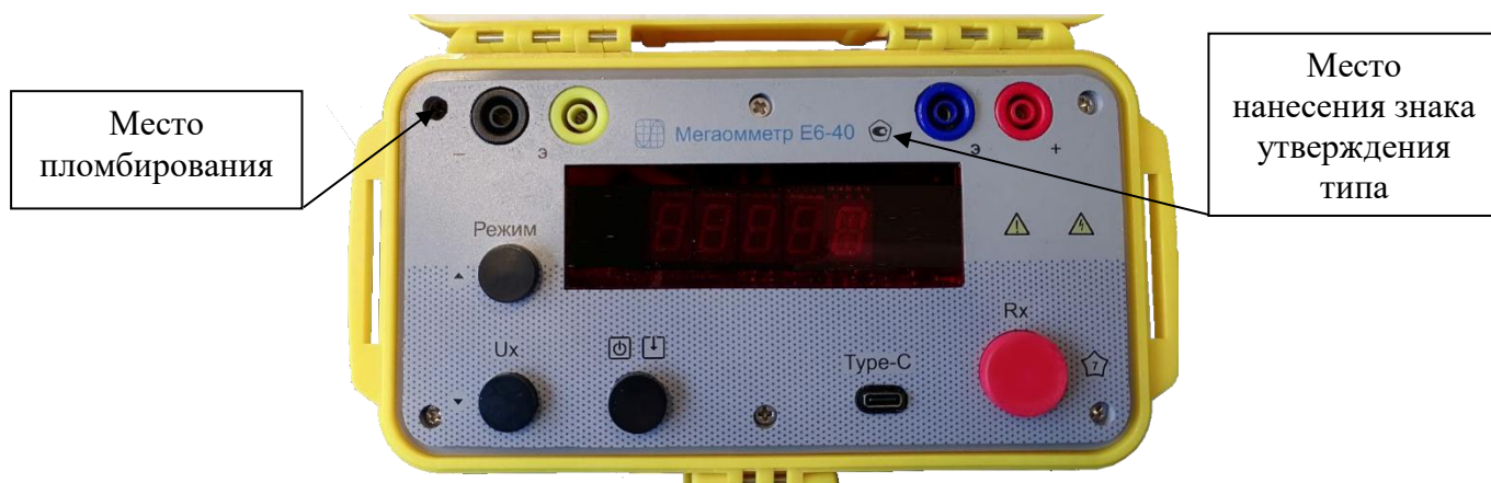
Рисунок 3 – Общий вид мегаомметров Е6-40 (горизонтальное исполнение корпуса)
