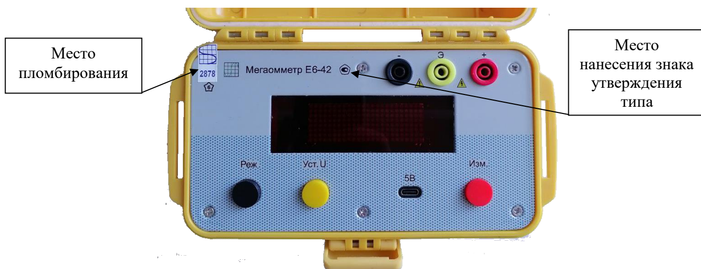
Рисунок 5 – Общий вид мегаомметров Е6-42
