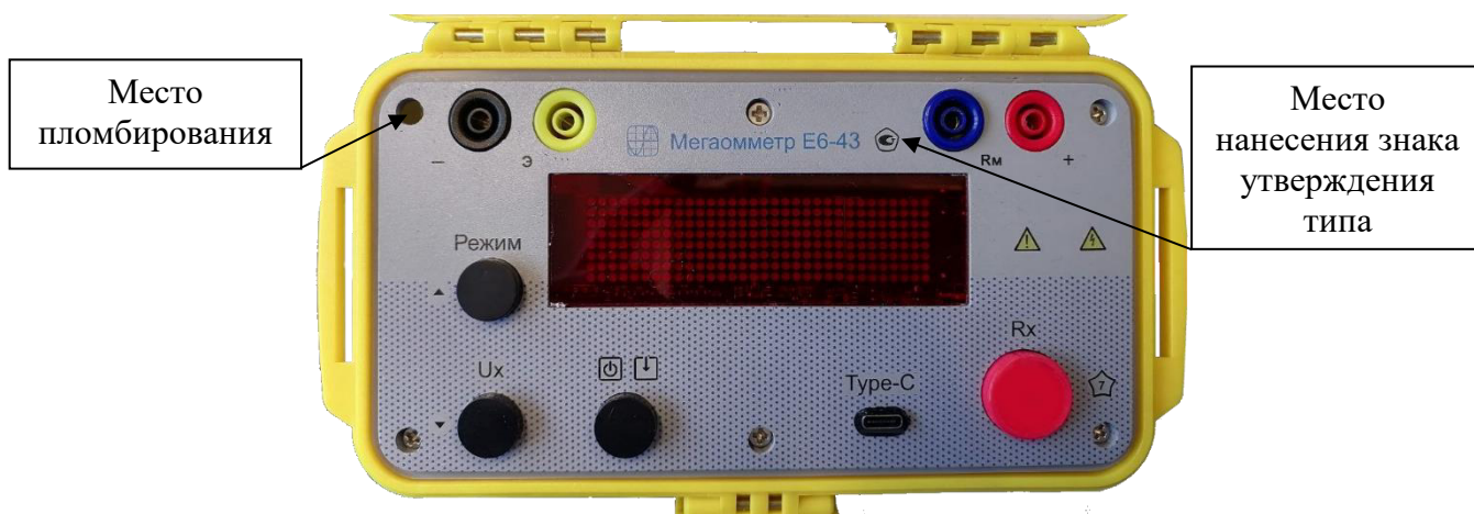
Рисунок 6 – Общий вид мегаомметров Е6-43
