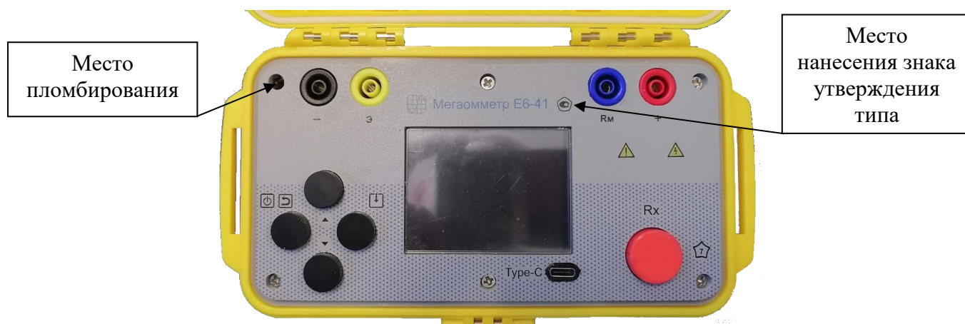
Рисунок 4 – Общий вид мегаомметров Е6-41 (горизонтальное исполнение корпуса)
