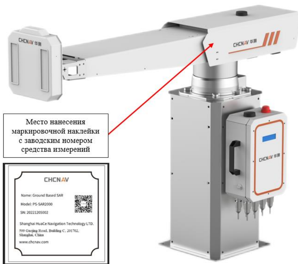
Рисунок 1 – Общий вид измерителей малых перемещений поверхностей
