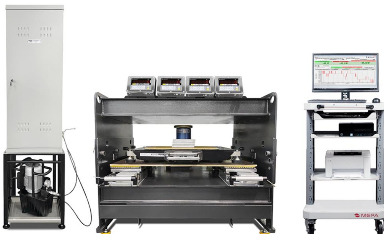
Рисунок 1 – Общий вид Устройства (шкаф-блок с гидروпомпой (слева), станина с контрольными весами и гидродомкратом (в центре), управляющий компьютер (справа))
