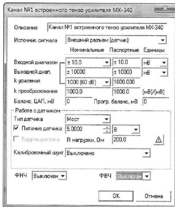
Рисунок 25 - Окно настройки встроенного тензоусилителя модуля MX-340 для поверки ИК напряжения на измерительной диагонали тензометрического датчика
