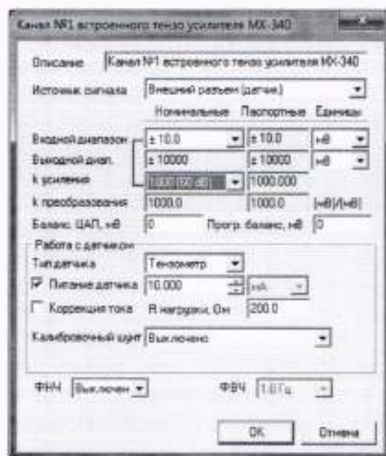
Рисунок 23 - Окно настройки встроенного тензоусилителя модуля MX-340 для проверки канала питания тензометра током
