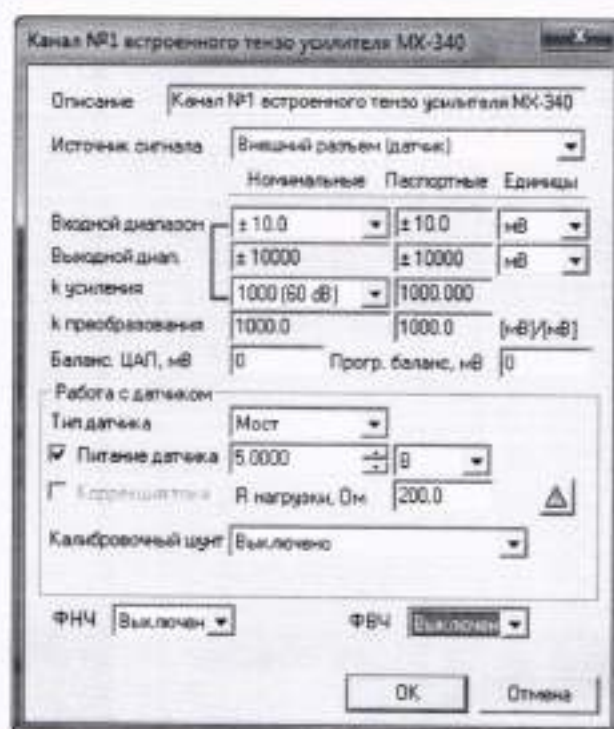
Рисунок 25 - Окно настройки встроенного тензоусилителя модуля MX-340 для поверки ИК напряжения на измерительной диагонали тензометрического моста
