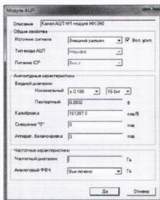
Рисунок 22 - Окно настройки АЦП канала модуля MX-340 для поверки канала питания тензорезистора током
