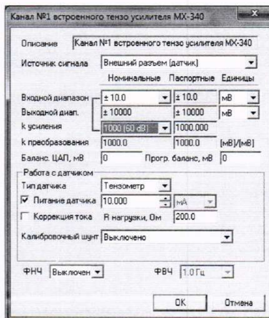
Рисунок 23 - Окно настройки встроенного тензоусилителя модуля MX-340 для поверки канала питания тензометра током
