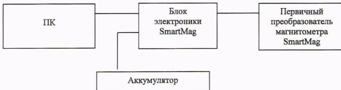
Рисунок 3 - Схема подключения магнитометра SmartMag
