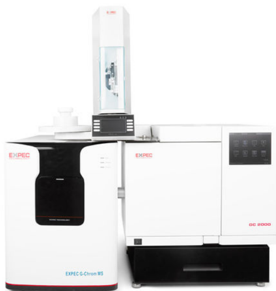
Рисунок 1 - Общий вид хромато-масс-спектрометров газовых с тройным квадруполом EXPEC G-Chrom MS с газовым хроматографом GC 2000 в исполнении 1
