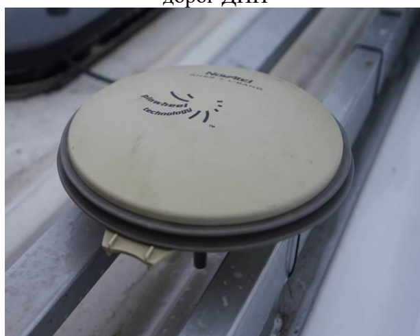
Рисунок 4 - Измеритель углов поворота автомобильных дорог МИГ2
