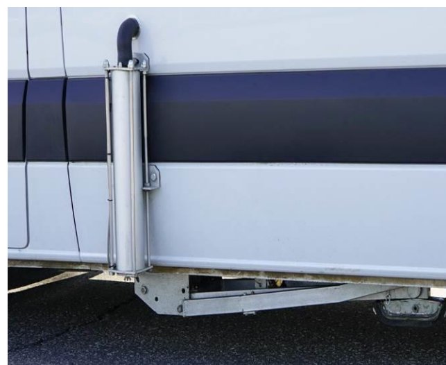
Рисунок 5 - Измеритель ординат продольного микропрофиля покрытия автомобильных дорог ПКПР
