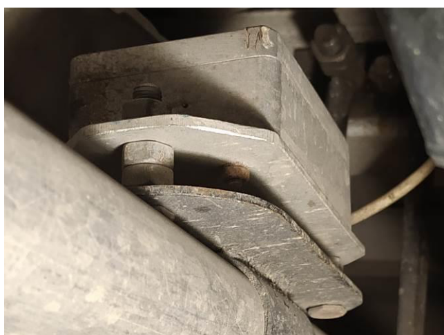
Рисунок 3 – Измеритель продольных и поперечных уклонов МИГ1
