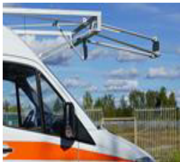
Рисунок 8 - Измеритель глубины колеи покрытия автомобильных дорог ПКК
