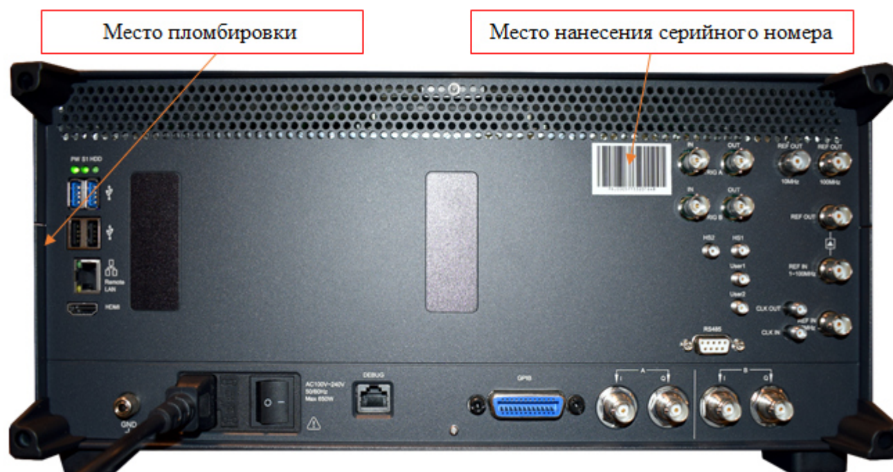
Рисунок 2 – Схема пломбировки от несанкционированного доступа и место нанесения серийного номера, идентифицирующего каждый экземпляр СИ
