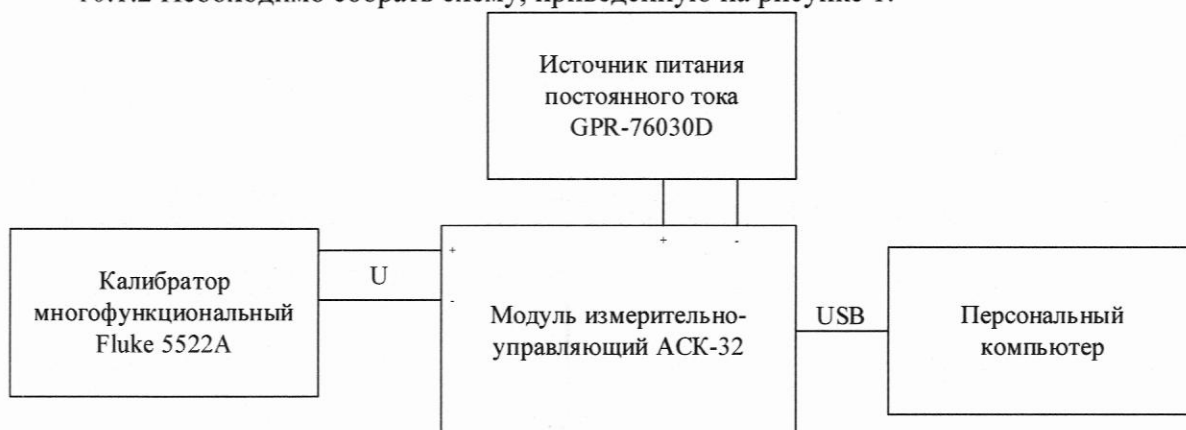
Рисунок 1 – схема определения приведенной (к верхнему пределу воспроизведений) погрешности измерений напряжения постоянного тока
