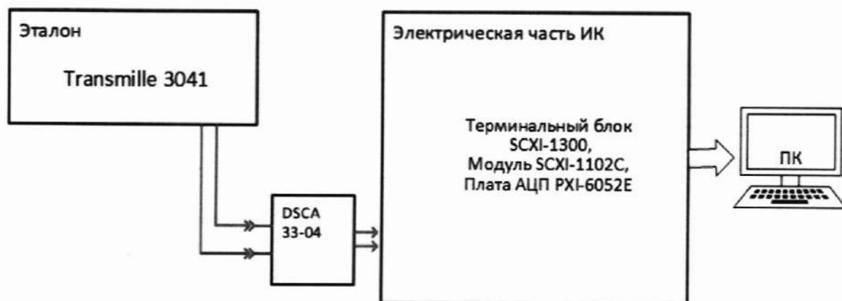
Рисунок 11 – Схема поверки ИК фазового напряжения в цепи нагрузки генератора переменного тока
