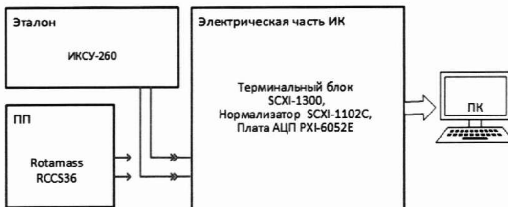
Рисунок 1 – Схема поверки ИК массового расхода топлива
