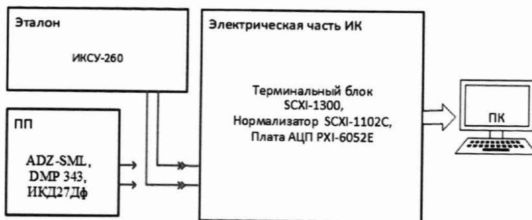
Рисунок 5– Схема поверки ИК избыточных и разности давлений поэлементным способом
