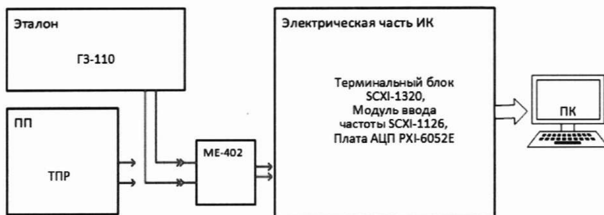
Рисунок 2 – Схема поверки ИК объемного расхода (прокачки) жидкости
