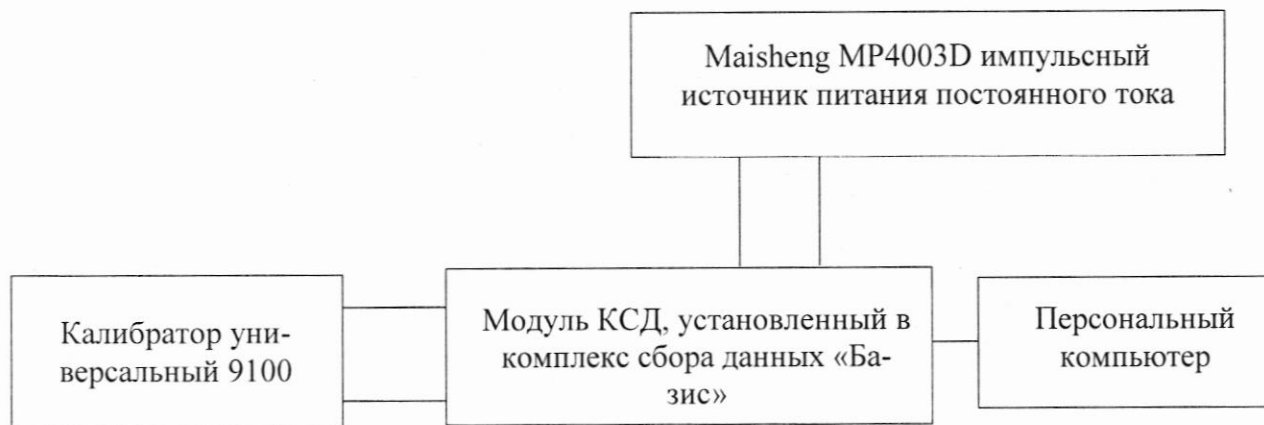
Рисунок 1 – Схема подключений для определение приведенной, к диапазону преобразований, погрешности преобразования напряжения постоянного тока и преобразований электрического сопротивления постоянному току
