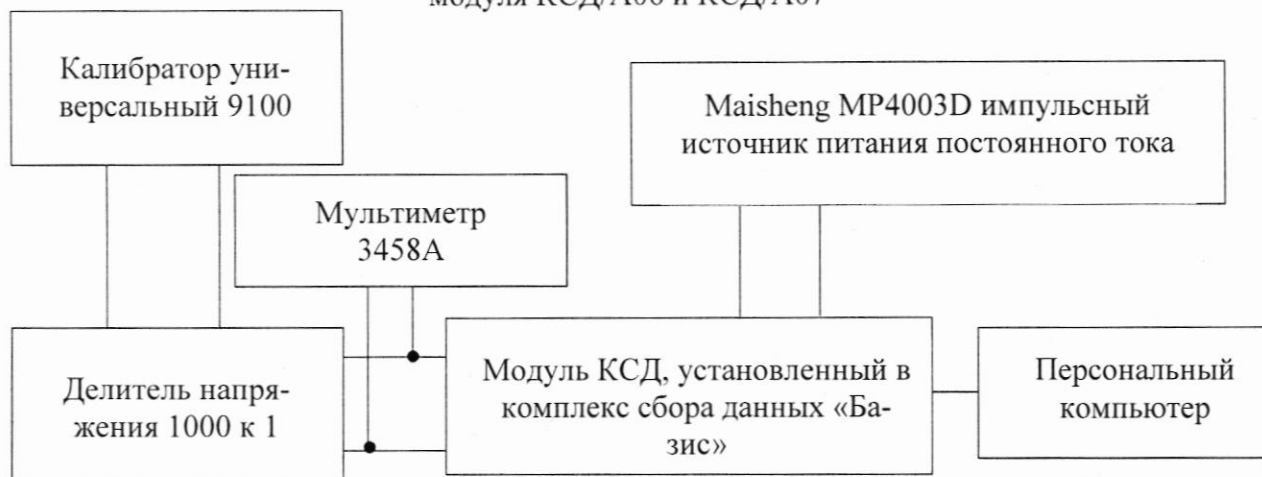
Рисунок 3 – Схема подключений для определения приведенной, к диапазону преобразований, погрешности преобразований амплитудного значения напряжения переменного тока
