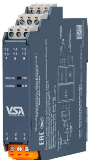
а) преобразователи с установкой на DIN-рейку, шириной 17,8 мм
