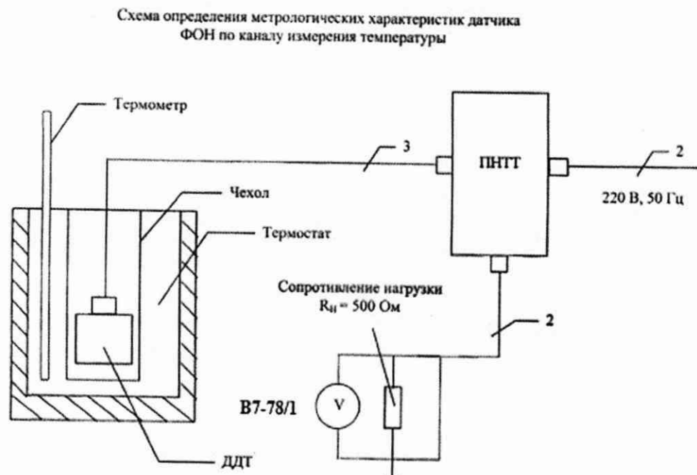
Рисунок 2 – Схема определения основной погрешности по каналу измерения температуры
