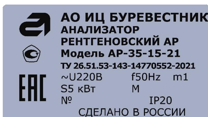
Рисунок 2 – Вид фирменной таблички с заводским номером и знаком утверждения типа анализаторов рентгеновских АР
