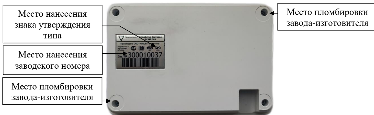
Рисунок 4 – Обозначение мест нанесения знака утверждения типа, заводского номера, а также схема пломбировки от несанкционированного доступа
