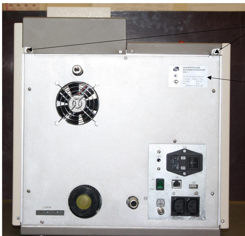
Рисунок 2 – Место маркировки и место нанесения знака утверждения типа, места для пломбирования анализаторов серы волнодисперсионных АСВ-2
