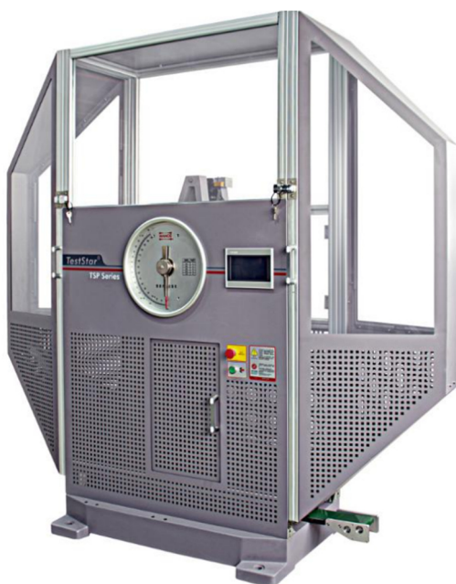
Рисунок 3 – Общий вид копров маятниковых модификаций PIT752H-2, PIT752H-3, PIT752H-4
