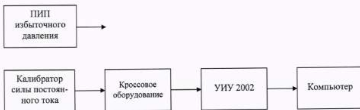
б) Схема определения метрологических характеристик поэлементным способом
