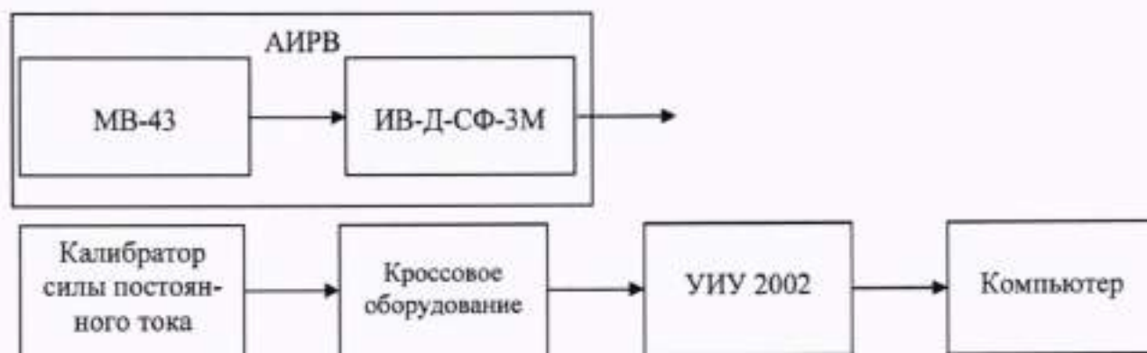
Рисунок 9 - Схема определения метрологических характеристик ИК виброскорости
