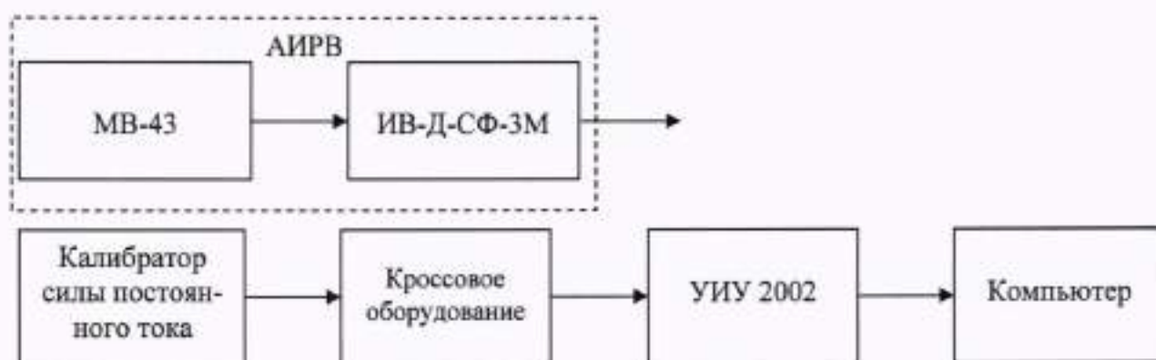
Рисунок 8 - Схема определения метрологических характеристик ИК силы постоянного тока, соответствующей значениям виброскорости
