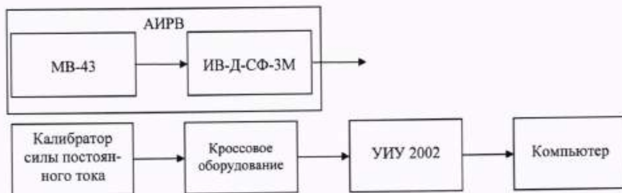
Рисунок 11 - Схема определения метрологических характеристик ИК виброускорения
