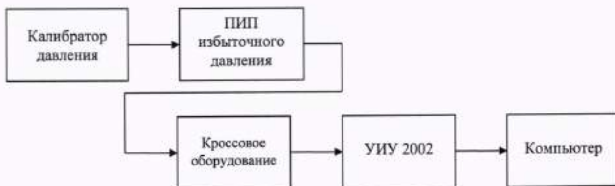
а) Схема определения метрологических характеристик комплектным способом
