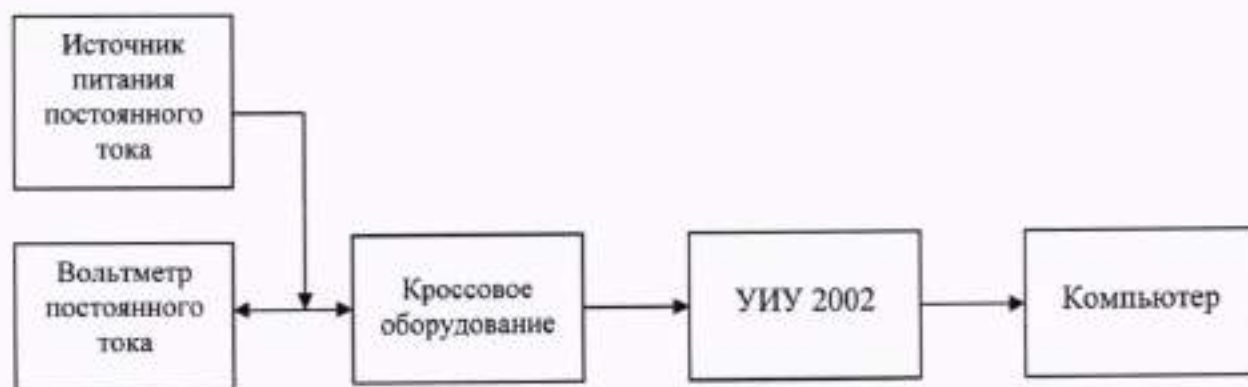
Рисунок 12 - Схема определения метрологических характеристик ИК напряжения постоянного тока
