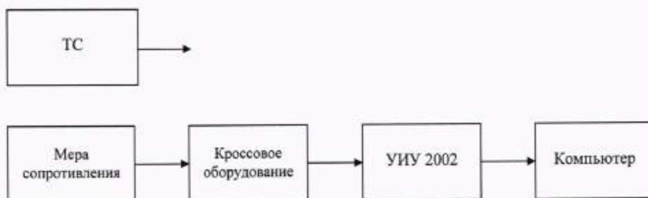
б) Схема определения метрологических характеристик поэлементным способом
