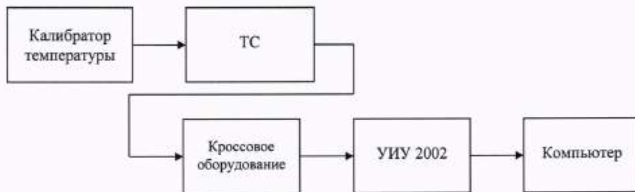
а) Схема определения метрологических характеристик комплектным способом
