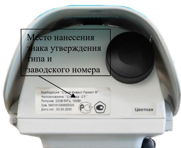
Рисунок 5 – Место нанесения знака утверждения типа и заводского номера на видео модуль
