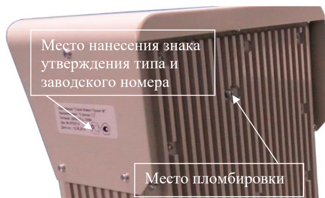
Рисунок 4 – Схема пломбировки RD модуля и место нанесения знака утверждения типа и заводского номера
