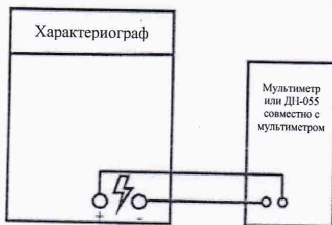
Рисунок 3 – Схема подключения для определения абсолютной погрешности измерений обратного напряжения диода
