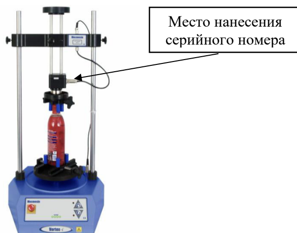
Рисунок 4 – Общий вид измерителей крутящего момента силы Vortex-i с указанием места нанесения серийного номера
