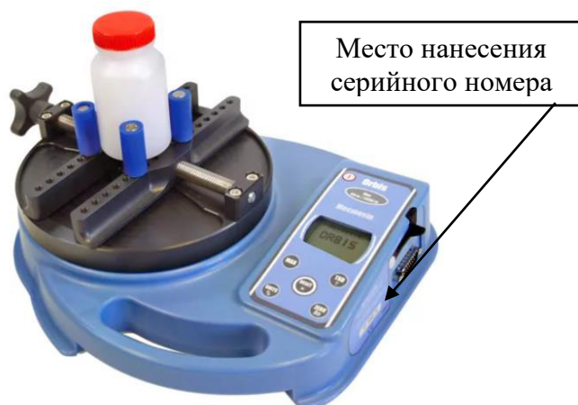
Рисунок 1 – Общий вид измерителей крутящего момента силы Orbis с указанием места нанесения серийного номера
