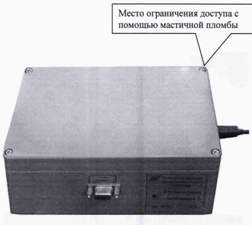
Рисунок 2 – Схема пломбировки блока согласования
