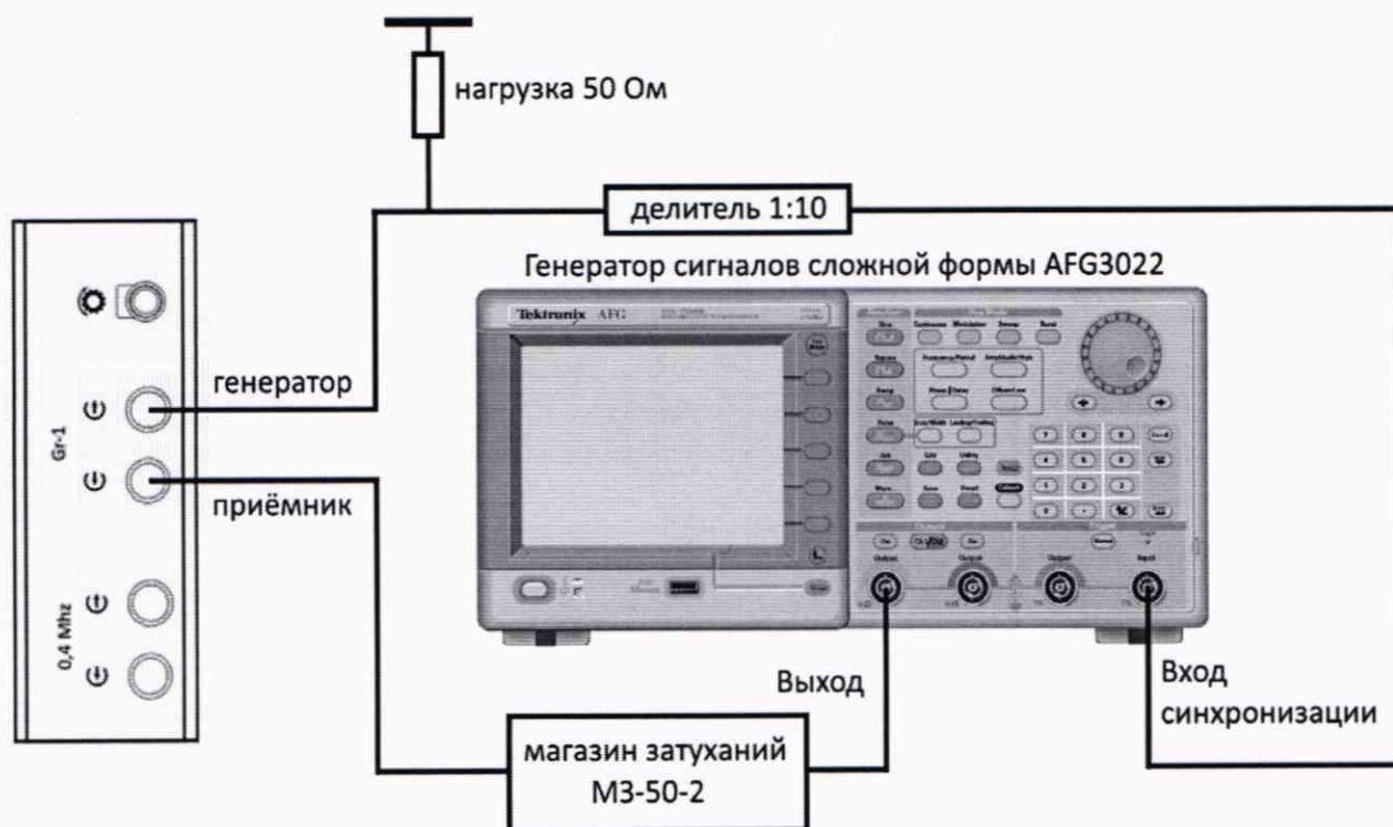
Рисунок 2 – Схема соединения для определения абсолютной погрешности измерений отношений амплитуд сигналов на входе приемника
