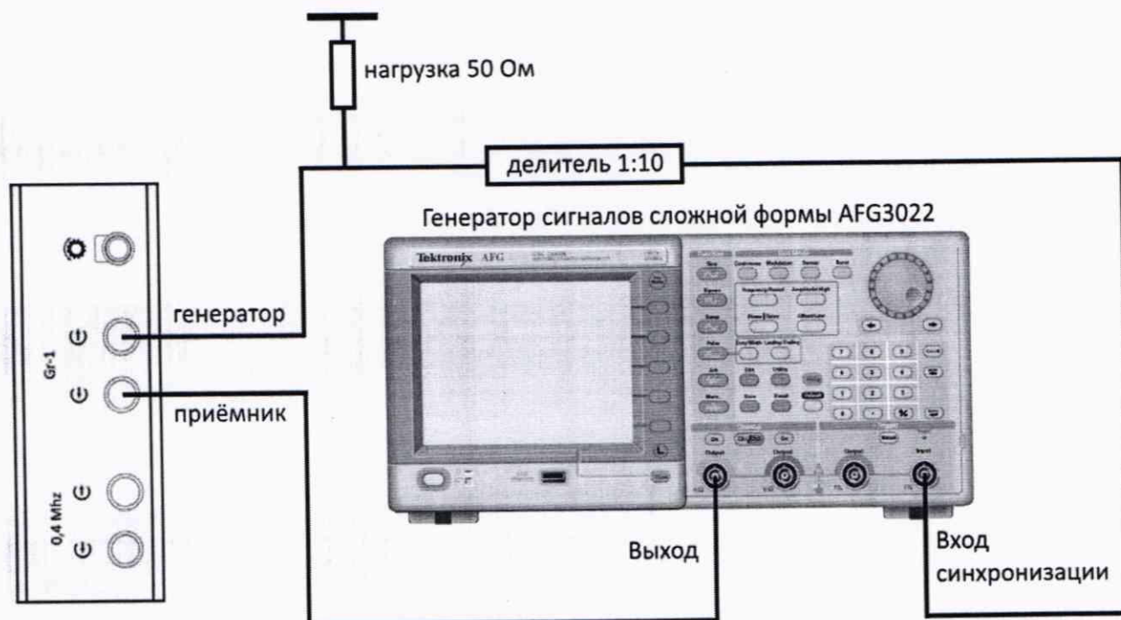
Рисунок 1 – Схема соединения для определения абсолютной погрешности измерений длительности временных интервалов
