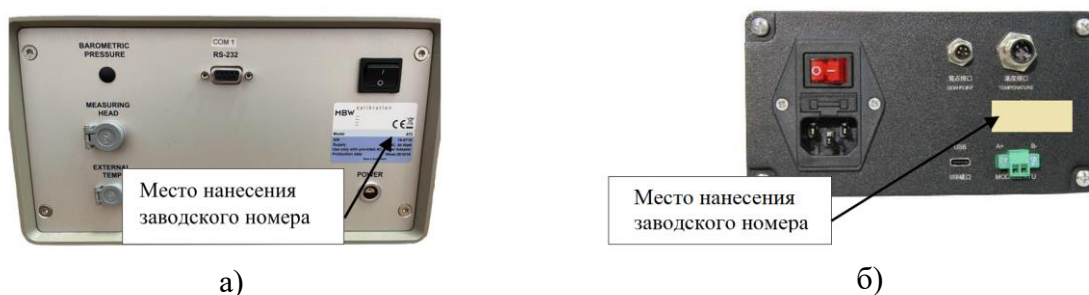
Рисунок 4 - Внешний вид задних панелей контрольных гигрометров 473-RP2 Dew Point Mirror а) и DPM.2201 б).
