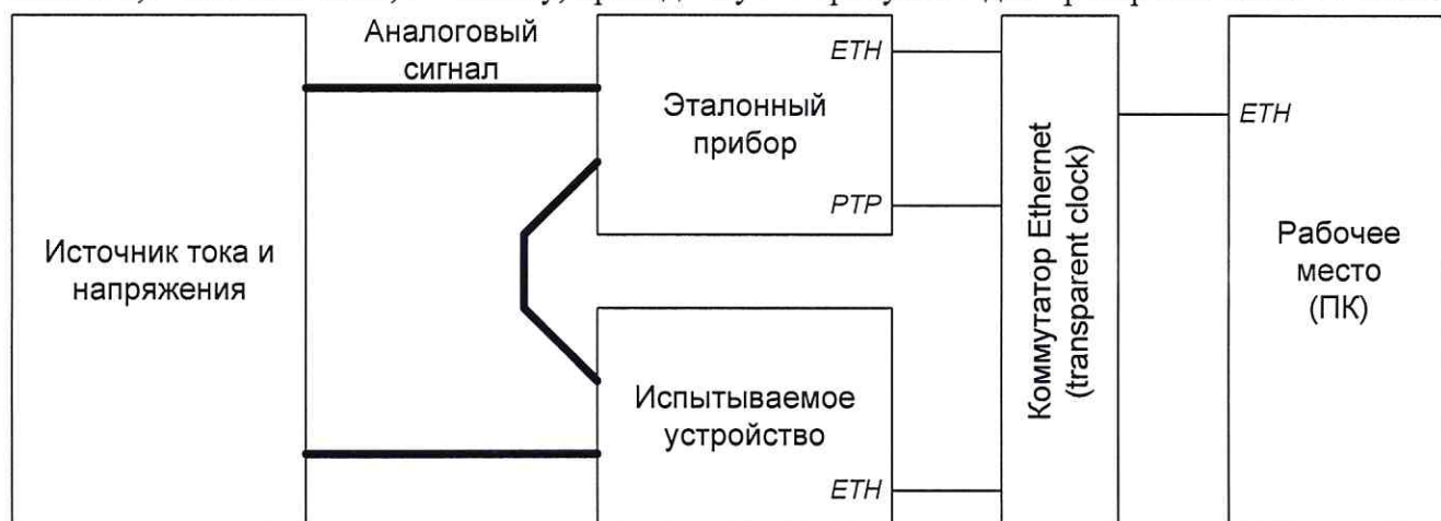
Рисунок 3 – Схема стенда для проверки метрологических характеристик модуля измерения тока для целей релейной защиты и автоматики (для проверки в точках 0,2 \cdot I_{ном} и 2 \cdot I_{ном} )
