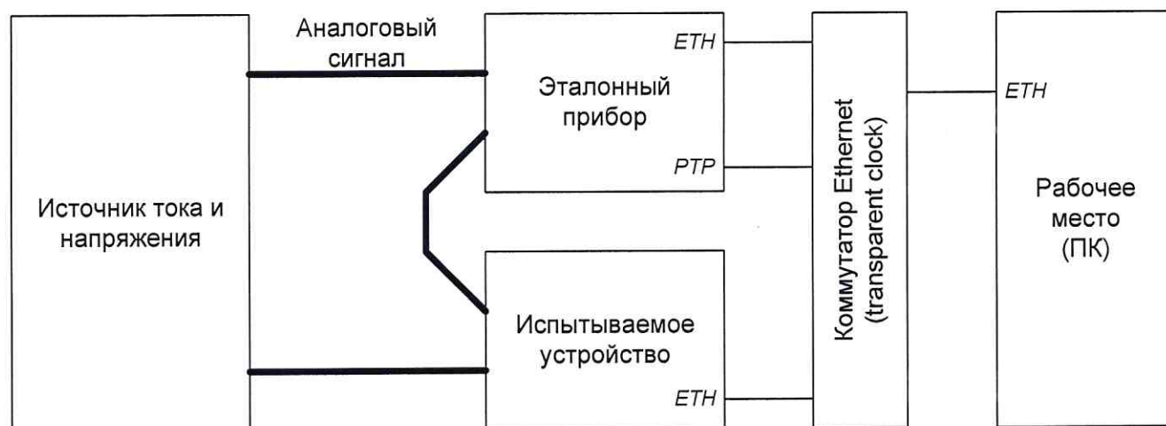
Рисунок 1 – Схема стенда для проверки метрологических характеристик модуля измерения тока
