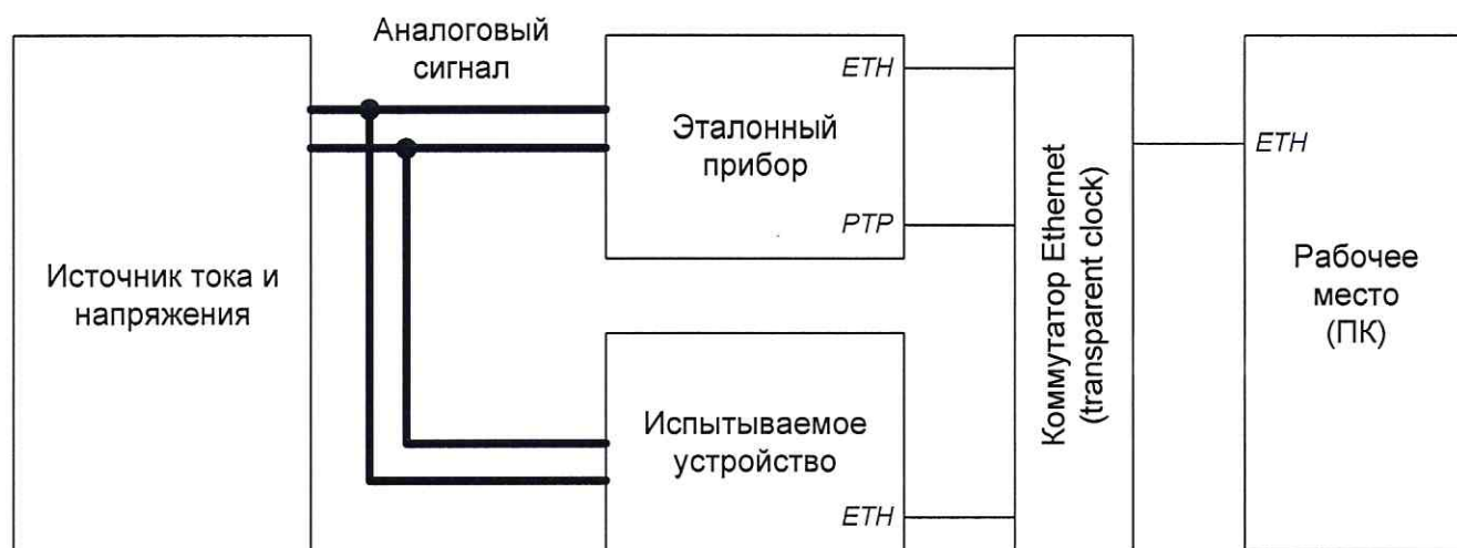
Рисунок 6 – Схема стенда для проверки метрологических характеристик модуля измерения напряжения релейной защиты и автоматики (VT-P) в части каналов для измерительных цепей отбора напряжения
