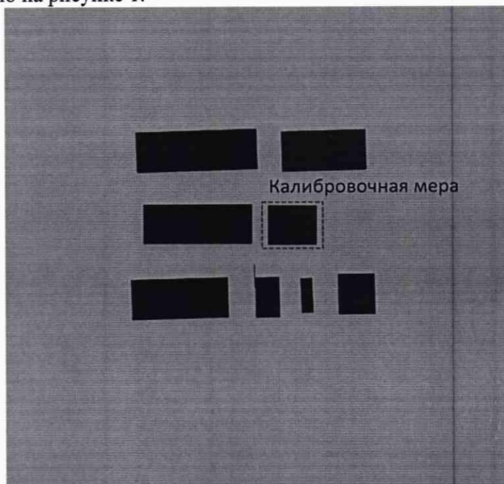
Рисунок 1 – Положение мер из комплекта концевых мер длины на рабочем поле детектора
