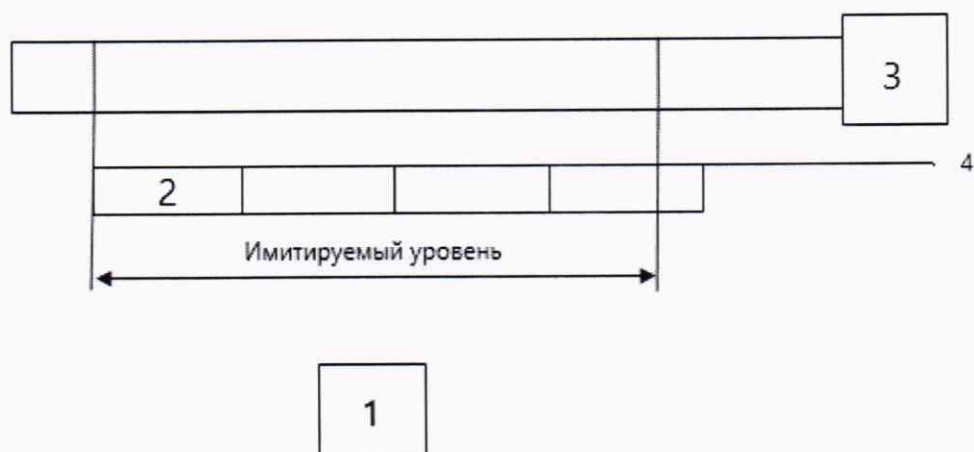
Рисунок Б.1 – Схема проверки с помощью блоков свинцовых на месте эксплуатации
